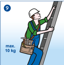
9 max. 10 kg Immer eine Hand an der Leiter. Lasten bis max. 10 kg mitführen.
