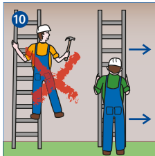
10 Nicht seitlich hinauslehnen, sondern Leitern/Tritte versetzen.
