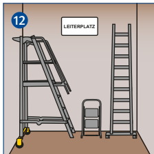
12 Leitern und Tritte gegen schädigende Einflüsse (Witterung, Fahrverkehr) geschützt lagern.
