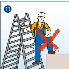
11 Stehleitern nicht als Aufstieg zu höher gelegenen Arbeitsplätzen verwenden.
