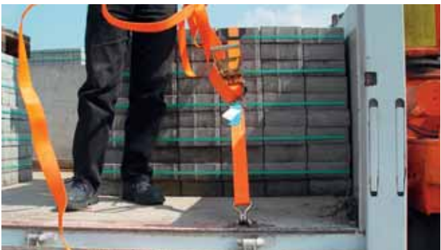
Ladung immer erst ausreichend sichern, dann starten
