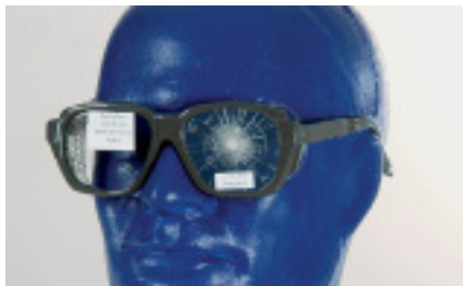
Auch Verbundglas kann die Kugel bei 45 m/s nicht stoppen.
