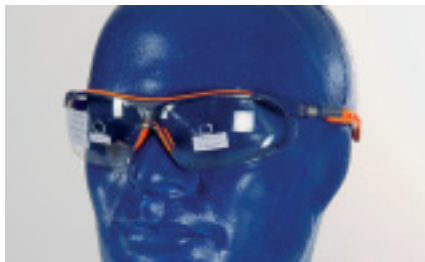
45 m/s machen dieser Schutzbrille aus Polycarbonat gar nichts aus: nicht mal ein Kratzer ist zu entdecken (rechtes Glas). Bei einer Geschwindigkeit von 70 m/s hinterlässt die Kugel kaum Spuren: nur eine kleine Delle bleibt (linkes Glas).
