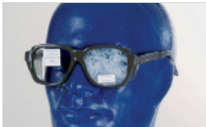
Hartglas zersplittert schon bei 45 m/s.
