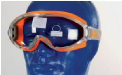
An dieser Schutzbrille prallt die Kugel selbst bei einer Geschwindigkeit von 120 m/s einfach ab. Es ist nur eine Delle zu sehen.
