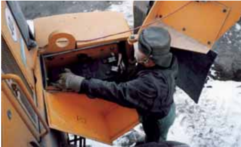
Beim Wechseln von Fahrzeugbatterien – Schutzbrille aufsetzen
