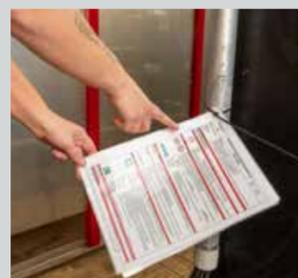
Die Betriebsanweisung weist auf Gefahren im Umgang mit Natronlauge hin. Diese kann ätzen, aber auch explosionsfähigen Wasserstoff freisetzen.
