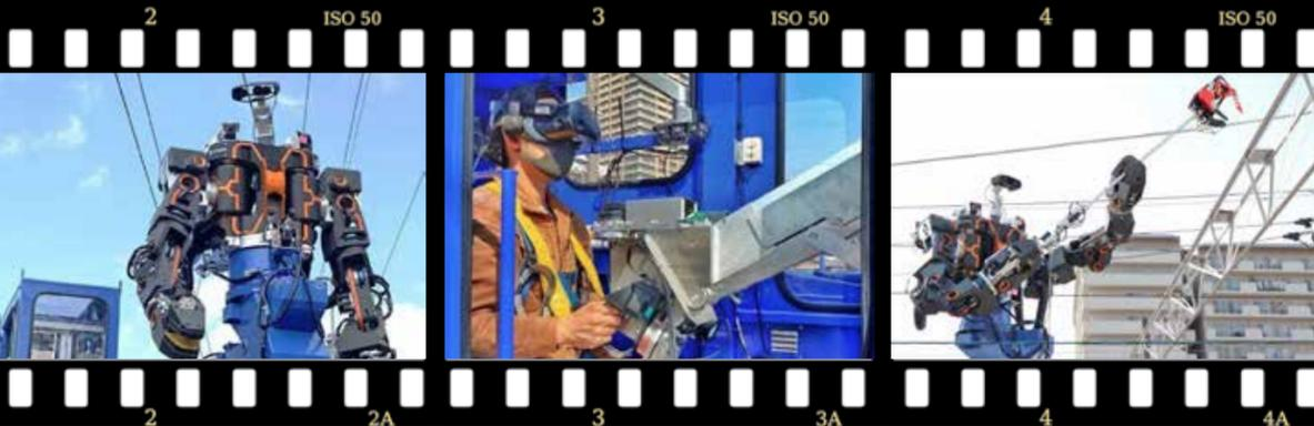
Instandhalten von Hochspannungsleitungen. Das ist die Aufgabe dieses Riesenroboters. Er ist an einem Hydraulikkran befestigt. Und hat einen menschenähnlichen Körper mit zwei Armen und Händen. Um Mitarbeiter davor zu schützen, am Stromschlag oder durch Absturz zu sterben.
