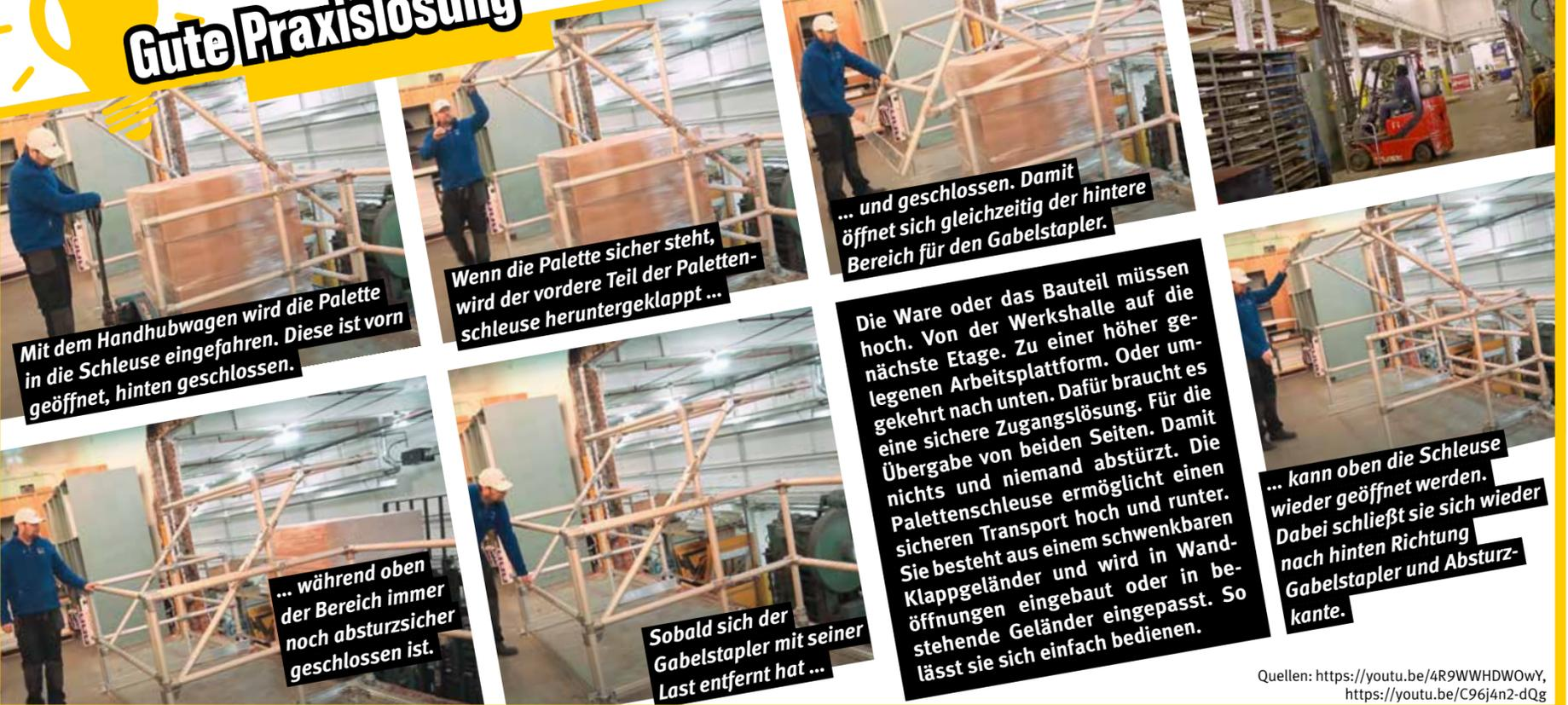
Mit dem Handhubwagen wird die Palette in die Schleuse eingefahren. Diese ist vorn geöffnet, hinten geschlossen.
