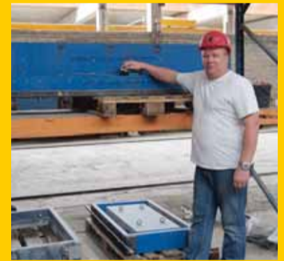
Im Formenlager: Dirk Hasekamp demonstriert die Kunststoffform mit Luftbedüsung zum leichten Entschalen.
