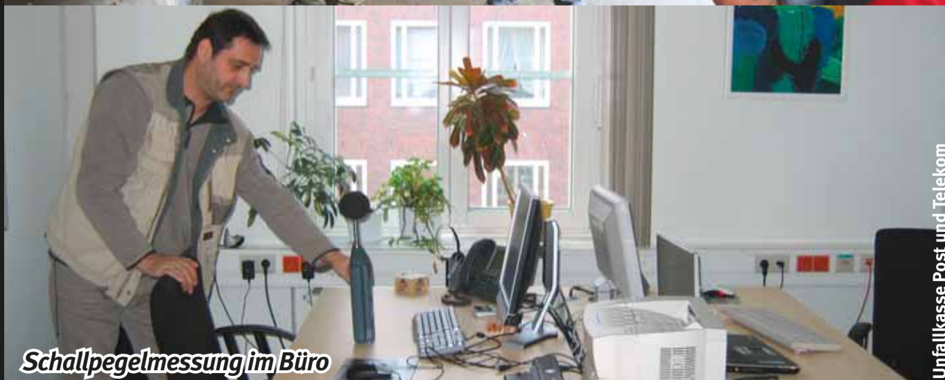
Schallpegelmessung an einem lärmintensiven Arbeitsplatz
