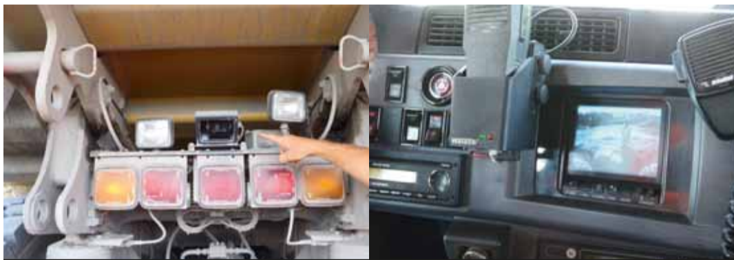
Angebracht am Heck des Fahrzeugs zeigt die Kamera...
