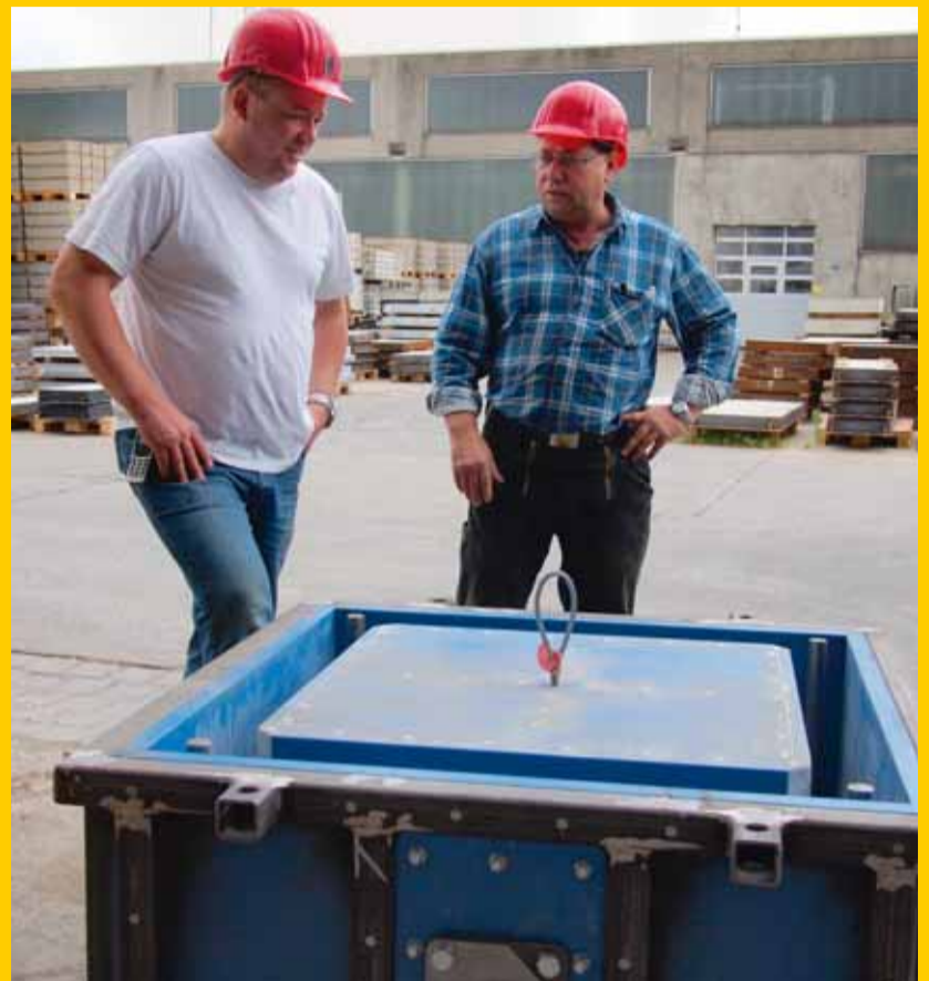
Werkmeister und Sicherheitsfachkraft Dirk Hasekamp (links) und Dieter Godehardt, Werkmeister Schreinerei und Fertigteile (rechts), zeigen die neuentwickelte Dreh-Zieh-Form mit Stahlrahmen zur Verstärkung.
