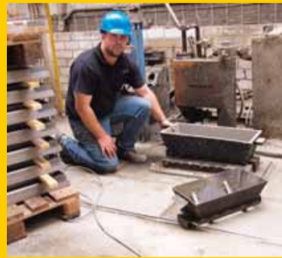
Vorher – nachher: Vorarbeiter Daniel Rosburg zeigt den Fülltrichter aus Kunststoff. Im Vordergrund: der alte Trichter aus Stahl – eine lästige Lärmquelle.
