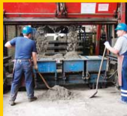
Die Stahlbetonbauer Christopher Stanke und Srkadi Reger betonieren zwei Kunststoffformen auf dem Rüttelbalken einer Humarbo-Maschine.
