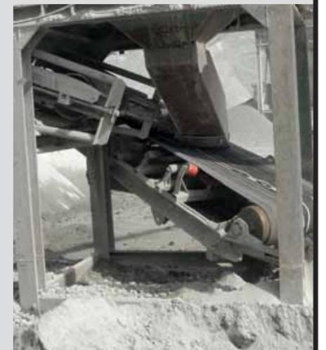
An Trommeln und Rollen, wo der Gurt umgelenkt wird, besteht erhebliche Einzugsgefahr.
