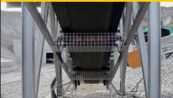
Bis zu einer Reichhöhe von 2,50 m angebracht, verhindern Schutzvorrichtungen an Untergurtrollen, dass Körperteile, Kleidung oder Gegenstände erfasst und eingezogen werden können.
