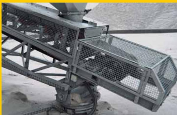
So sieht eine geeignete Schutzvorrichtung an einer Umlenk-/Spanntrummel aus.
