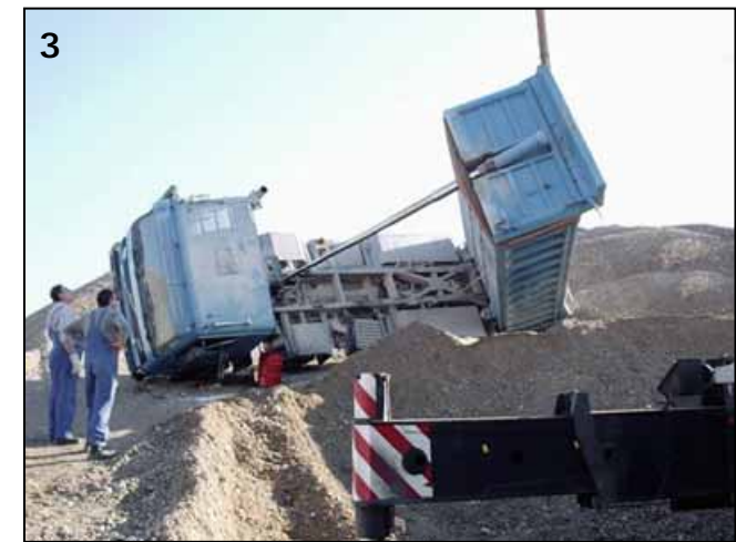
▲ Die Schwerpunktverlagerung beim Abkippen und das Überrollen eines Materialhaufens haben den Riesen von den Rädern gehobelt.
