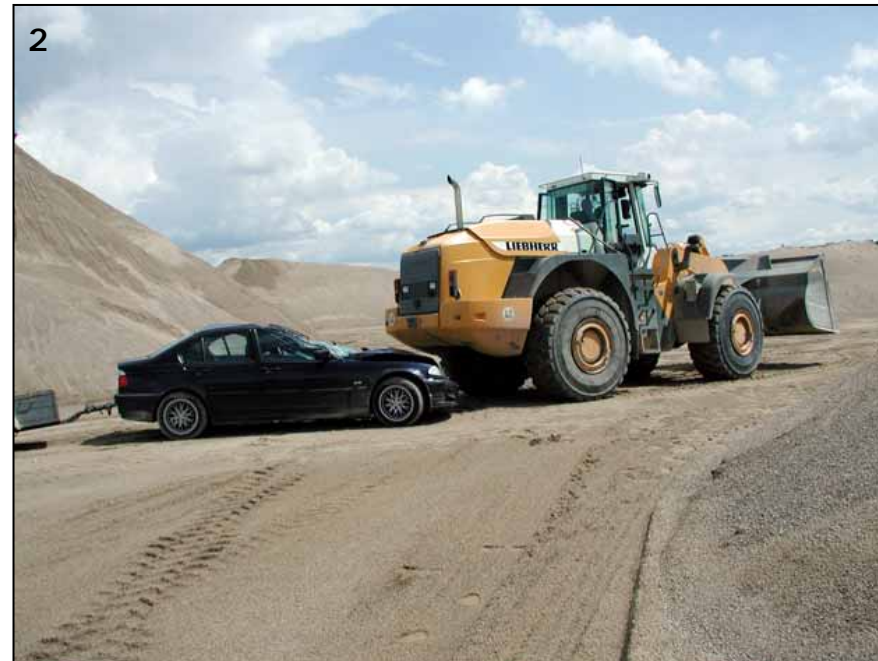
▲ Beim Rückwärtsfahren ist die Sicht des Radladerfahrers nach hinten gleich null.
