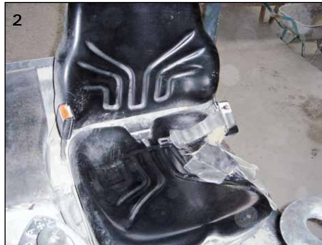
▲ Der Stapler war mit einem Sicherheitsgurt ausgerüstet, den der Fahrer jedoch nicht benutzte.
