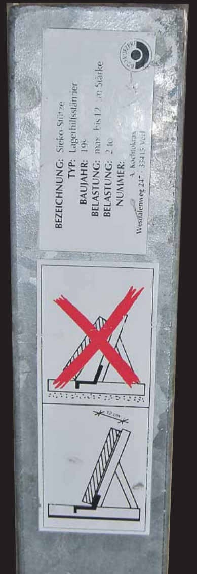
Der Sicherheitshinweis am Hilfsständer zeigt den richtigen Anlehnwinkel.
