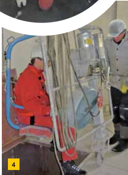
4 Nach dem Ausfahren aus dem Silo: Schwenken Sie den Sitz von der Befahrungsöffnung auf festen Siloboden. Lösen Sie die Seilsicherung vom Befahrungssitz und steigen Sie ab.
