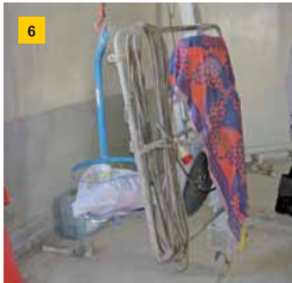
6 Legen Sie die PSA ab und verpacken Sie sie. Verschwenken Sie die Befahreinrichtung in deren Ruheposition. Steigen Sie vom Silo ab.
