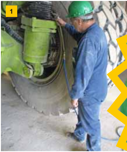
1 Die Hydraulik des Dumpers ist total verschmutzt. Vorarbeiter Artur Walter will den Dreck schnell beseitigen und greift zur Druckluftpistole.
