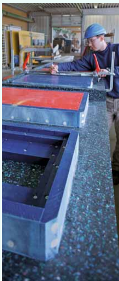
Kunststoffformen zur lärmreduzierten Herstellung von Betonteilen
