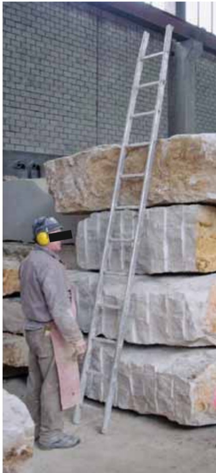
Nachgestellt: Die Leiter rutschte weg, als sich Robert H. zur Seite lehnte, um die Seilschlinge über die Blockkante zu werfen.
