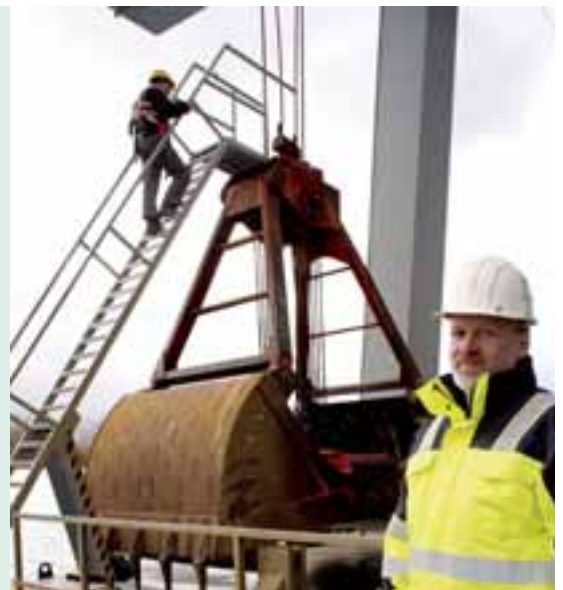
Die schwenkbare Treppenleiter mit Arbeitsbühne von Heinz Schlecht macht Wartungsarbeiten am Schwimmbagger sicher.
