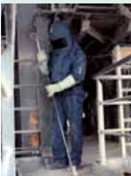
Bequem und hitzebeständig: Gemeinsam mit den Mitarbeitern der Holcim (Deutschland) AG wurde dieser neue Schutzanzug für Heißmehlarbeiten entworfen.
