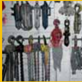
So werden Anschlagmittel ordnungsgemäß gelagert.
