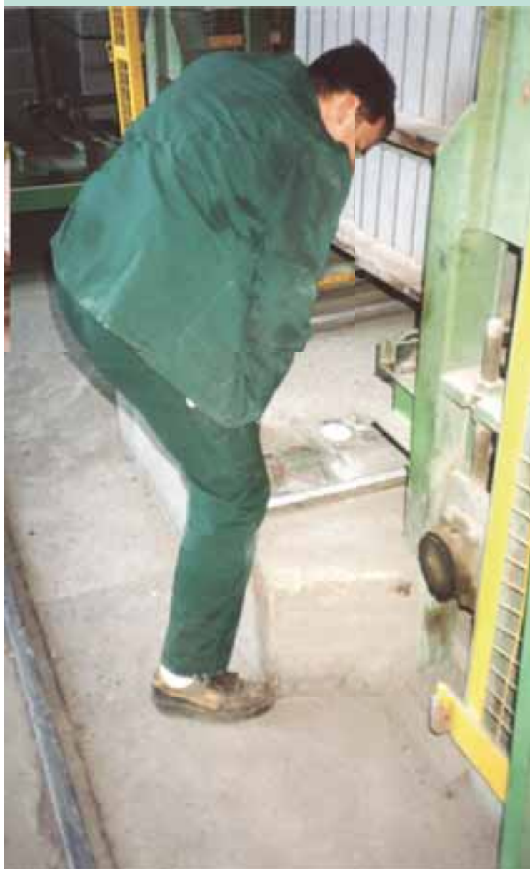
An einer senkrecht angeschweißten Öse wie dieser rutschte der Haken des Kettenzuges ab und schlug Franz mitten ins Gesicht.
