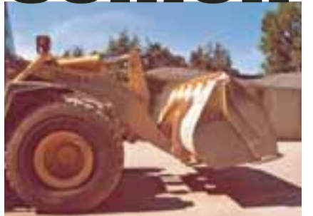
Der Abstand zwischen Unterkante der Schaufel und dem Führerhaus beträgt ca. 4,50 m bis 4,80 m.
