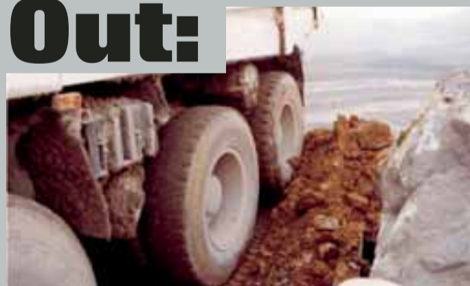
Absturzgefahr! Wer hier einen halben Meter weiter fährt, lernt die ewigen Jagdgründe kennen. Eine sichere Entladestelle befindet sich mindestens 5 m vor der Absturzkante und hat einen Anschlag mit mindestens 1/3 Höhe des Radurchmessers.
