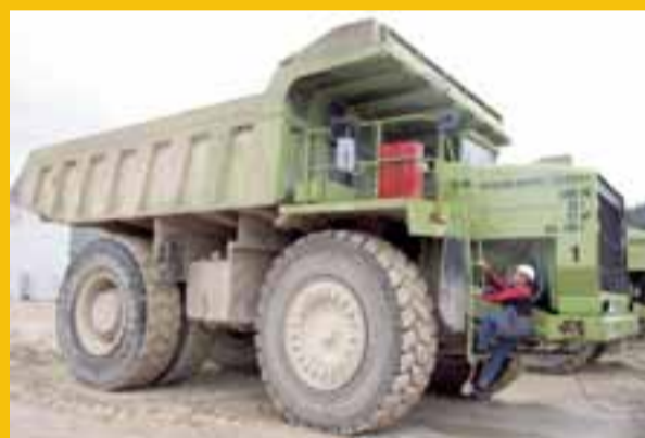
Hier wird der Abstand zwischen Leiter und Boden durch ein flexibles Leiterstück überbrückt – gut für die Knochen des Fahrers.
