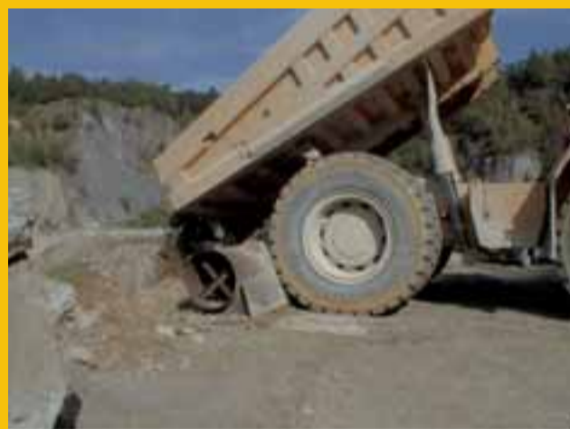
An Kippstellen wirken stabile Anschläge als „Bremsklotz“, um das Überfahren der Kippkante zu vermeiden.
