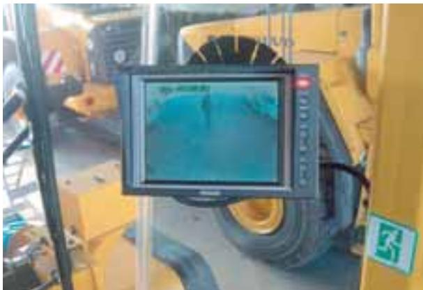
▲ **Eine Sichthilfe mit Kamera außen und Monitor in der Fahrerkabine erhöht die Sicherheit beim Rückwärtsfahren.**
