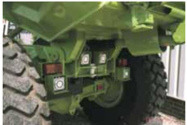
▲ **Rückfahr-Warneinrichtungen geben optische und/oder akustische Signale beim Zurücksetzen. Personen, die sich in der Nähe einer Erdbaumaschine aufhalten, werden so rechtzeitig gewarnt.**
