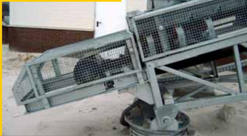
Mit Schutzgitter gesicherte Umlenkstrommel
