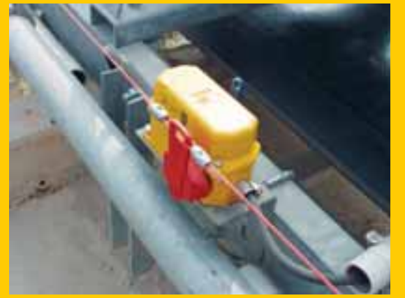
Die Reißleine als funktionsfähige Not-Aus-Einrichtung kann lebensrettend sein.
