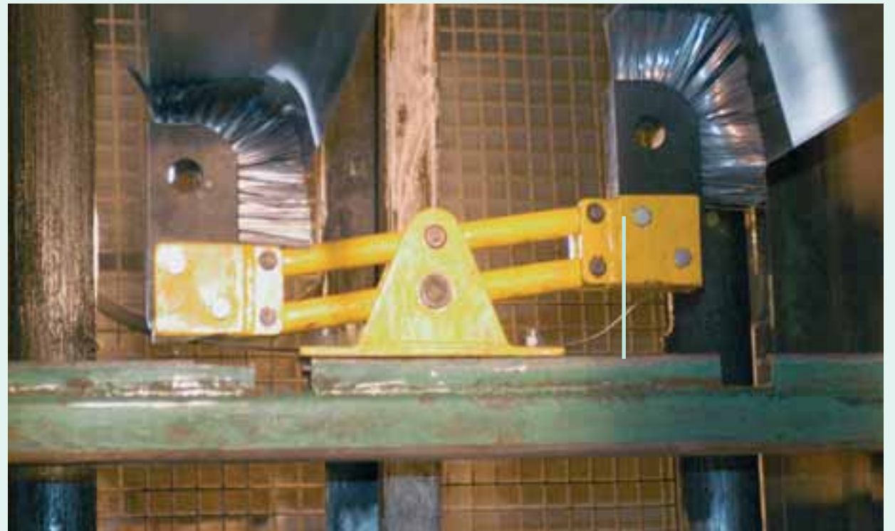
Die automatische Reinigungswippe macht nicht nur gefährliche Manipulationen überflüssig, sondern trägt sogar zur Steigerung der Produktivität bei.
