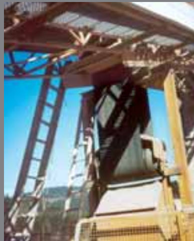
Halsbrecherische Wartungs- und Kontrollarbeiten am hochliegenden Förderband: Hier fehlt ein Laufsteg auf der richtigen Seite.
