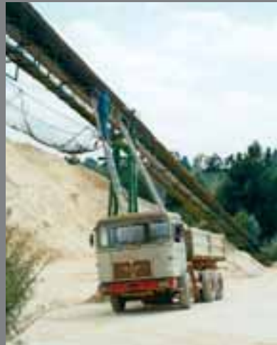
Halsbrecherische Wartungs- und Kontrollarbeiten am hochliegenden Förderband: Hier fehlt ein Laufsteg auf der richtigen Seite.
