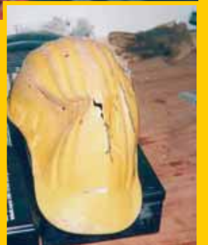
Der Sicherheitshelm wurde wie ein Brötchen zusammengedrückt.
