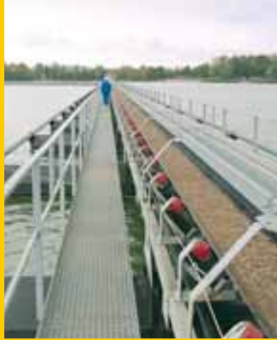
Untergurtrolle über einem Verkehrsweg mit Schutzabdeckung
