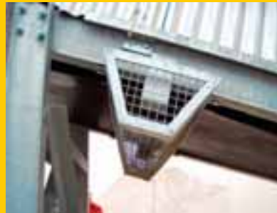
Untergurtrolle über einem Verkehrsweg mit Schutzabdeckung
