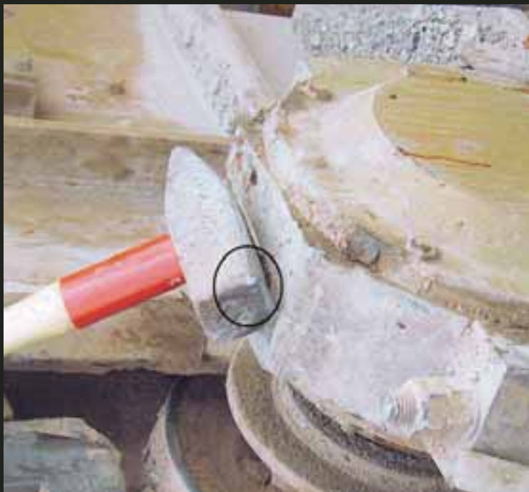
Von diesem Hammer löste sich ein linsengroßer Metallsplinter und schoss Mehmet Y. in die Halsschlagader.
