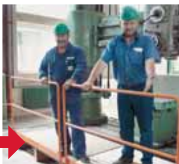
Die Lösung: Innerhalb weniger Tage wird sie beseitigt. Ein längeres Podest mit Geländer schließt in Zukunft Unfälle aus.
