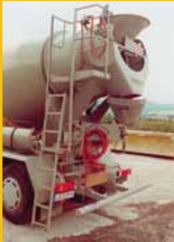
Ein stabiler Auf- und Abstieg, der dicht über dem Boden endet.
