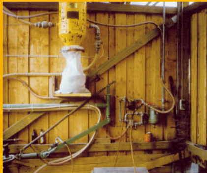
Mit diesem fest anliegenden Filtersack lassen sich gefilterte Stäube sicher auffangen und entsorgen.
