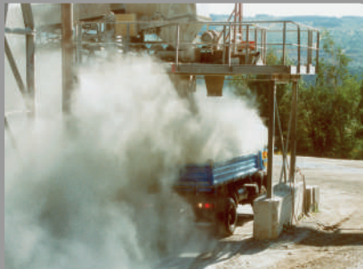
Fahrzeugbeladung ohne Schürzen. Die Staubwolke ist enorm.
