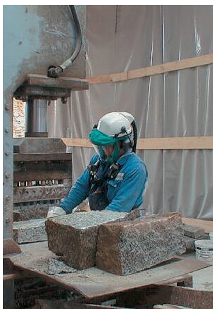
Ein Atemschutzhelm mit Gebläse ist bei körperlich anstrengenden Arbeiten besonders geeignet.
