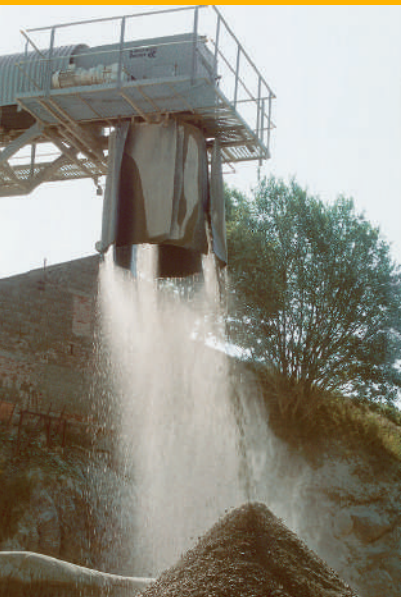
An der Bandabwurfstelle wird das Material befeuchtet, damit es nicht staubt.
