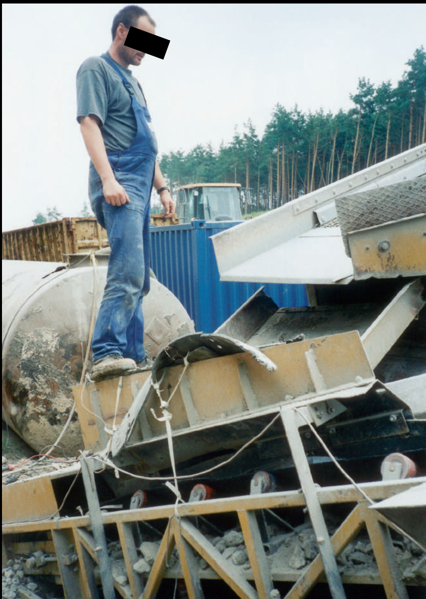
Nachgestellt: Manfred kletterte auf das Ende des Förderbandes – allerdings ohne Sieb und Förderband vorher abzuschalten.
