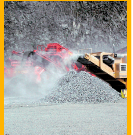
Staubwolken draußen entstehen am Förderband...
