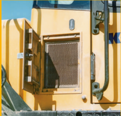
Für Prima Klima in der Fahrerkabine braucht man einen leicht zu reinigenden Filter: aber Feinstaubfilter bitte!
