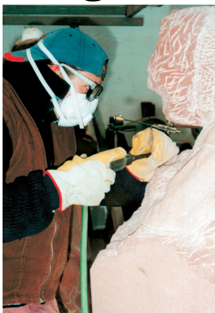
Halbmasken sind nur für kurzzeitige Tätigkeiten geeignet.
