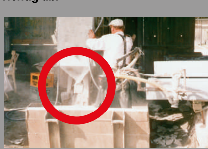
Vorsicht bei der Filterreinigung. Aus diesem offenen Behälter staubt's.
