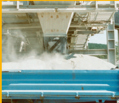
Fahrzeugbeladung mit absenkbarem Förderband und Schürzen. Die Staubentwicklung ist gering.
