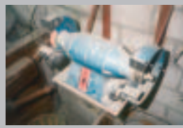
Dieser Schleifmaschine fehlt die Schutzscheibe. Sie so zu benutzen, ist äußerst riskant.
