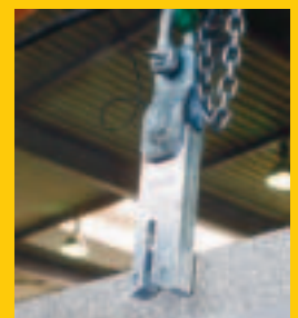
Der automatische Transporthaken wird vom Boden aus entriegelt.
