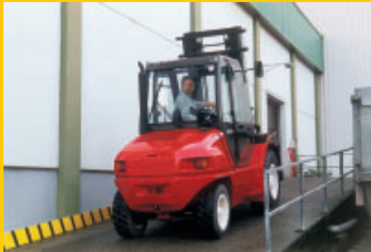
In: Bei Gefälle die Last bergseitig führen.
