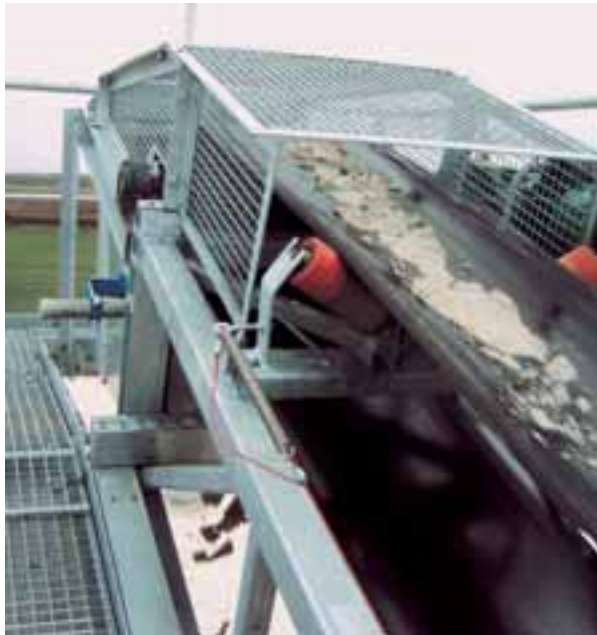
So sieht eine geeignete Schutz-einrichtung an einer Antriebs-trommel aus.
